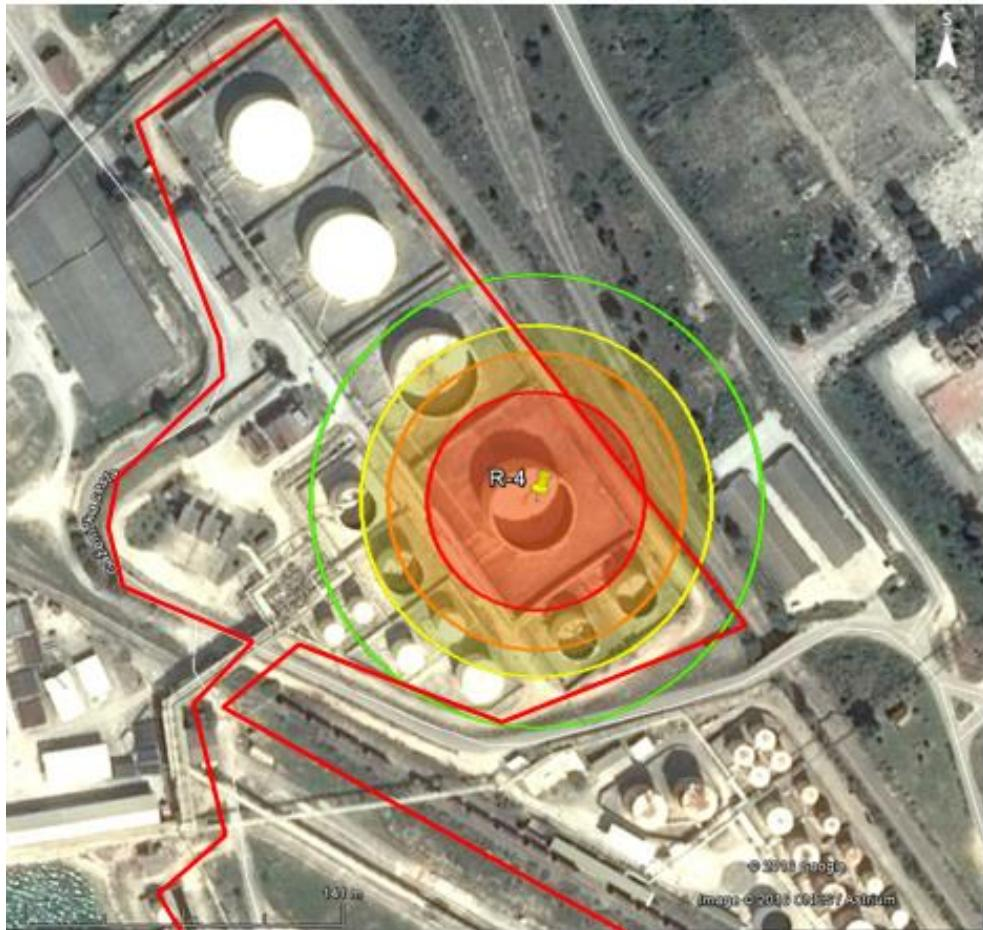
Slika 52. Zone ugroženosti uslijed zapaljenja dizela, manje istjecanje iz spremnika R-4
