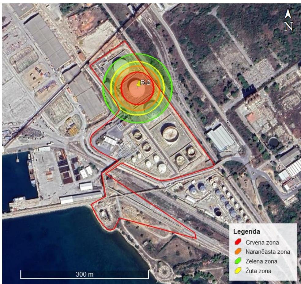
Slika 54. Zone ugroženosti uslijed istjecanja i zapaljenja dizela, manje istjecanje iz spremnik R-2 u tankvanu
